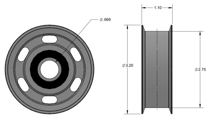
BEARING IS ON CENTERLINE OF THE PULLEY
